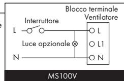
**Modello MS100VN:** per il funzionamento con ritardo di fine ciclo occorre che sia presente sul ventilatore una seconda fase continuamente sotto corrente.
