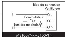
**MS100VN :** Une deuxième phase, permanente, est nécessaire pour une utilisation avec poursuite du fonctionnement.
